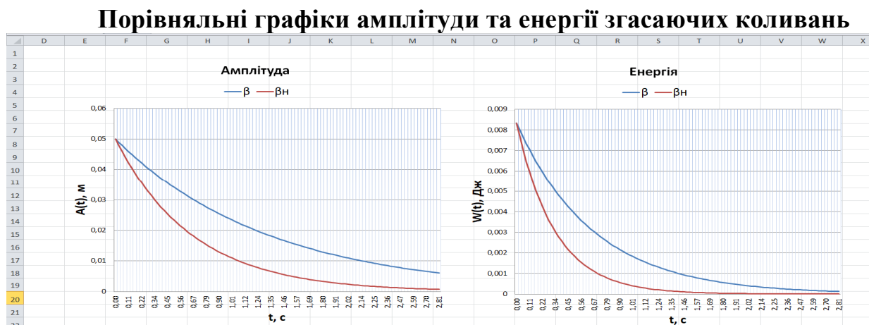
Рис. 2. Фрагмент результатів дослідження амплітуди та енергії згасаючих механічних коливань.
